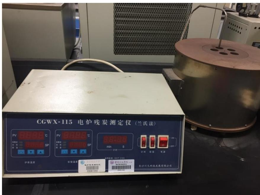
电炉残碳测定仪
