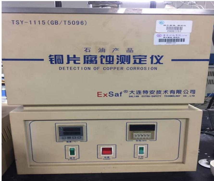
石油产品铜片腐蚀测定仪
